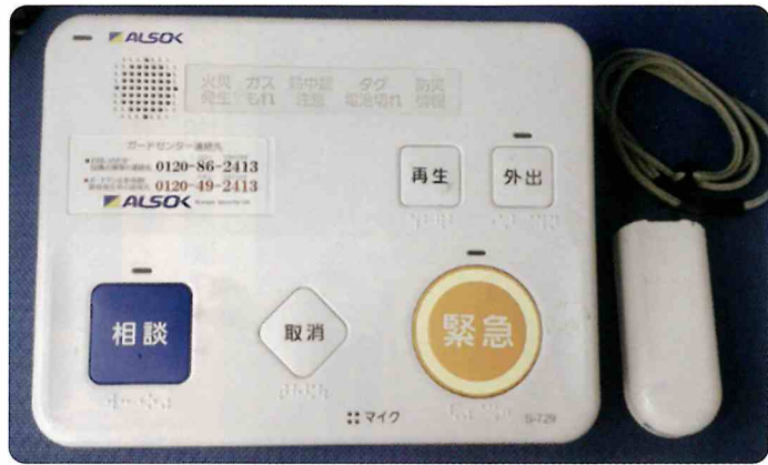
▲左：主装置、右：非常ペンダント。非常ペンダントは、携帯のできる在宅用の緊急ボタン。体の具合が悪くなった時などに押してください。
